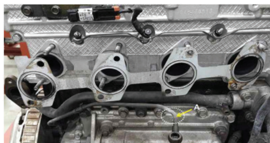
Şəkil 07-8: Turbo Şarj yağ kəmərinin quraşdırılması
