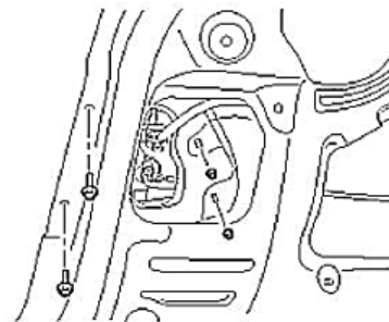
Şəkil 04-9: Lampa konstruksiyasının sökülməsi
