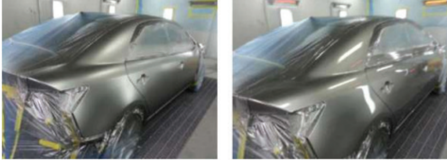
Şəkil 05-18: R/H qrupunun metal əsasının çəkilməsindən sonra şəffaf örtük örtüyünün çəkilməsi
