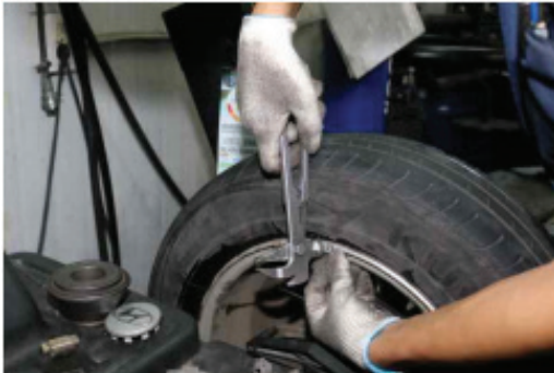
Şəkil 07-14: Çəkinin qoşulması
