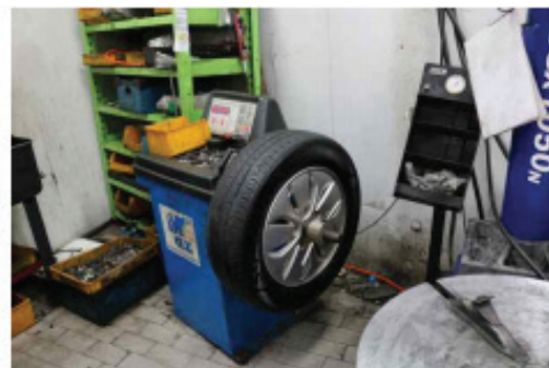
Şəkil 07-8: Təkəri tarazlıq sayğacına bərkitmə
