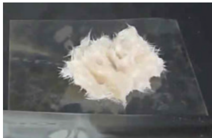
Şəkil 09-13: Şüşə lif birləşməsi
