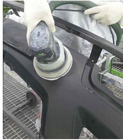
Şəkil 02-8: Pardaqlama dəzgahı ilə cilalama
