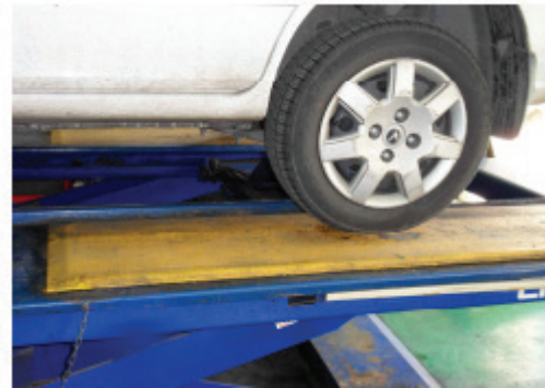
Şəkil 12-9: Arxa üfüqi dönmə stolunun quraşdırılması
