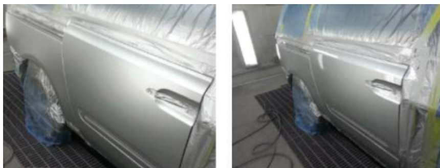
Şəkil 05-15: Sürüşən qapının və arxa kapotun metal əsasının çəkilməsindən sonra şəffaf örtük boyasının çəkmə əməliyyatı
