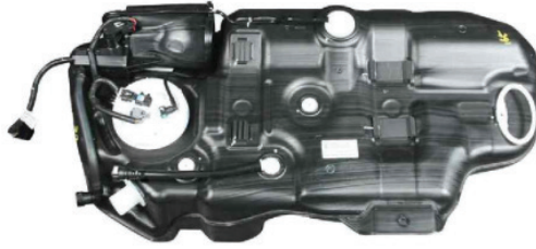
Şəkil 08-4: Yanacaq çəni və yanacaq nasosu
