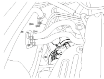
Şəkil 10-4: Birləşdirici boltun çıxarılması
