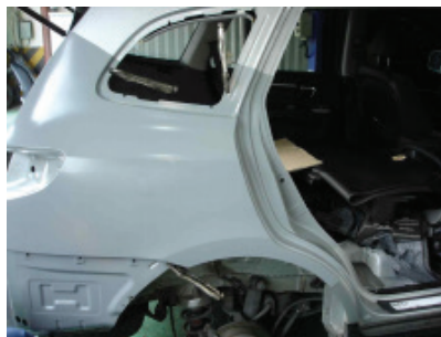
Şəkil 04-7: Yeni panelin yerləşdirilməsi əməliyyatı
