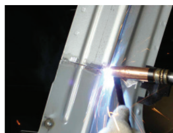
Şəkil 04-15: Panelin qaynaq edilmiş hissəsi
