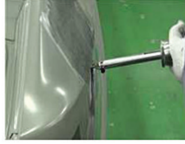
Şəkil 05-14: Press xəttinin düzəldilməsi
