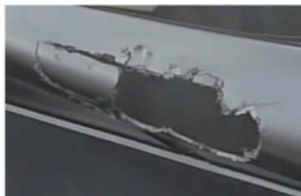
Şəkil 09-10: Zədələnmiş sahənin müəyyən edilməsi
