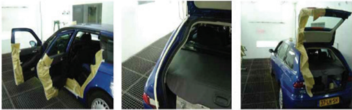
Şəkil 04-1: Kənarlardakı lövhələrə birlikdə qoruyucu örtüyün çəkilməsi
