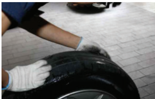
Şəkil 07-34: Şinin zədəsinin dəqiq yoxlanması
