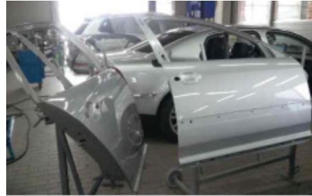
Şəkil 05-29: Ön və arxa qapılara suda həll olan metal əsaslı örtük çəkildikdən sonra şəffaf örtük boyasının çəkilməsi
