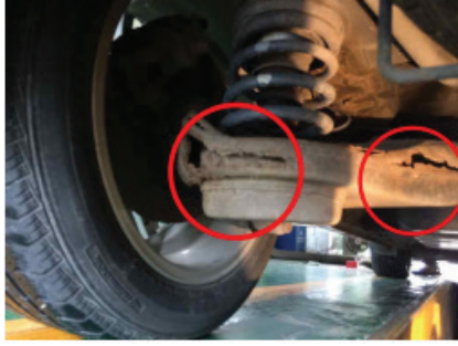
Şəkil VI, 02-9: Aşağı lignin korroziya səbəbi ilə zədələnməsi
