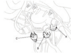
Şəkil 05-5: Su sensoru birləşdiricisi
