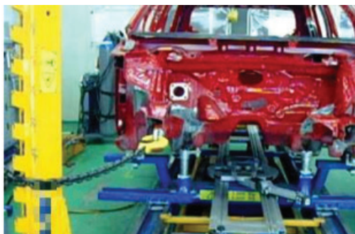
Şəkil 03-11: Fiksatorun aralanmasının qarşısının alınması
