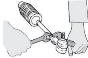
Şəkil 12-8: Qabaq təkərlərin nizamlanması
