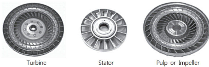
Şəkil 04-5: Hidrotransformatorun konfigurasiyası
