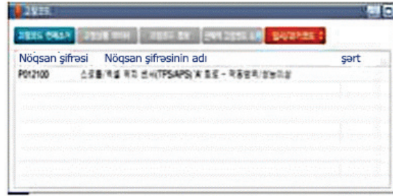
Şəkil 06-16: Drossel gövdəsinin vəziyyət sensor skanerinin yoxlanılması
