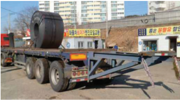
Şəkil VI, 01-9: İcazə verilən maksimum uzunluq pozulması
