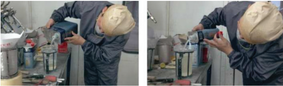
Şəkil 05-1: Təmiz üzləmə boyası və bərkidici maddə
