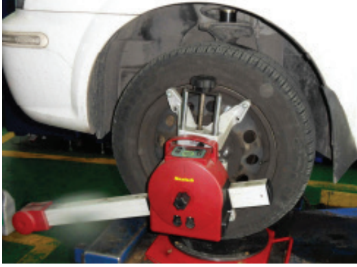
Şəkil 12-12: Sensorun başlığının quraşdırılması
