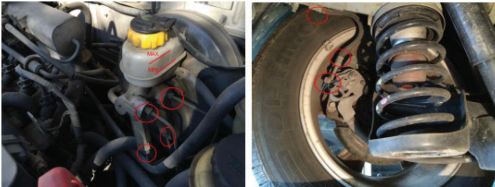
Şəkil VI, 02-15: Tormoz sızması üzrə yoxlanış sahəsi
