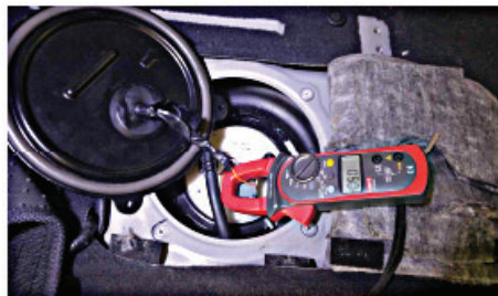
Şəkil 08-15: Yanacaq nasosundakı axını yoxlamaq (arxa oturacaqda, oturacağın altında)
