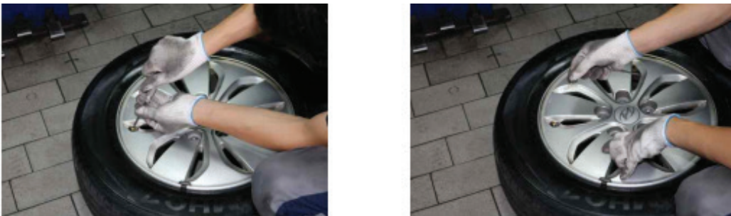
Şəkil 07-17: Şinlərin havasını boşaldın
