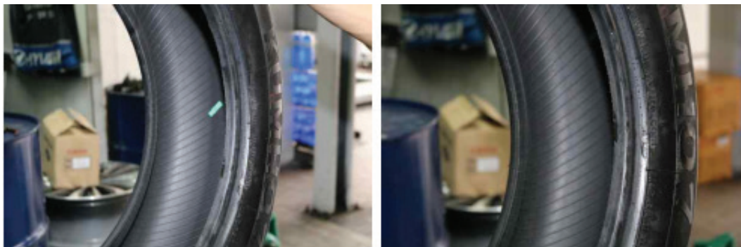
Şəkil 07-27: İşdən sonra şinin daxili hissəsini yoxlayın
