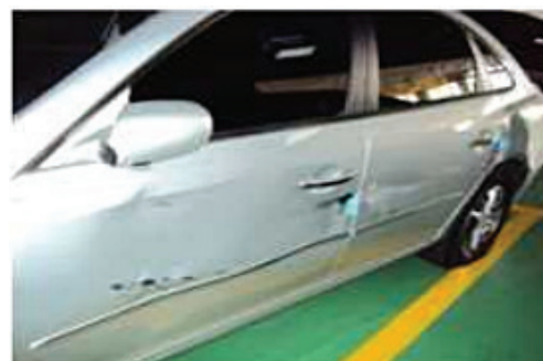
Şəkil 01-12: Xarici içlik panelinin zədələnmə dərəcəsinin müəyyən edilməsi
