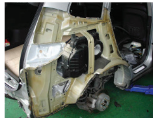
Şəkil 04-1: Zədələnmiş panelin sökülməsi
