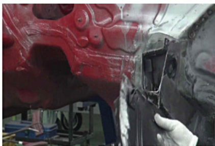
(Şəkil 06-16) Panelin ayrılması
