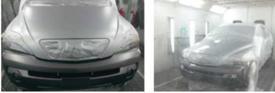
Şək 05-10: Ön bəmperə və kapota yuxarı və aşağı iki rəngli metal əsəşli örtük çəkilməsindən sonra şəffaf örtük boyasının çəkilməsi
