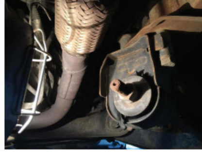
Şəkil VI, 02-10: Burulma çubuğunun zədələnməsi
