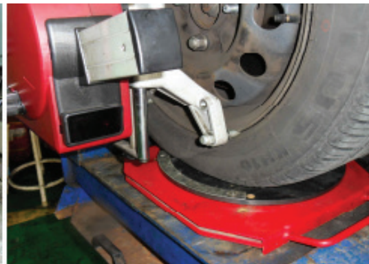
Şəkil 12-15: Tutacağı düz vəziyyətində aşağı salma
