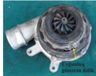
Şəkil 07-21: Kompresor qapağının / kaset dəstinin quraşdırılması
