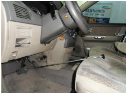
Şəkil 12-14: Əyləc nimçəsinin quraşdırılması
