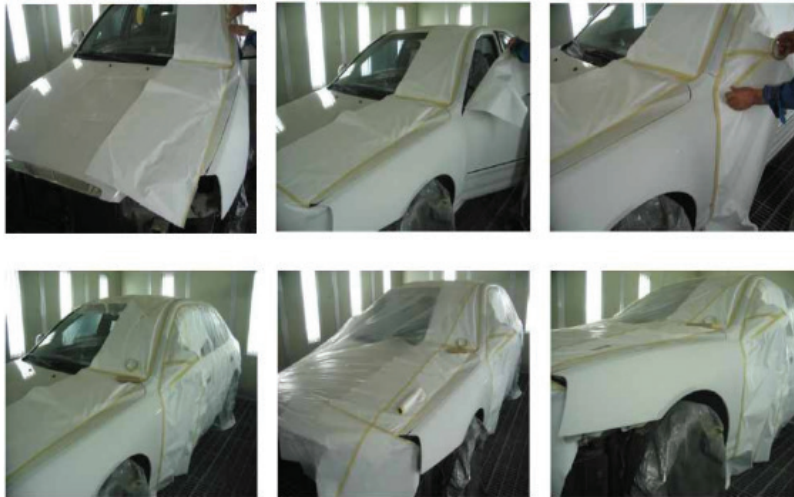
Şəkil 04-6: Ön lövhəyə qoruyucu örtük çəkilməsi
