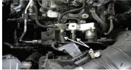
Şəkil 12-10: Yanacaq təchiz etmə xətti
