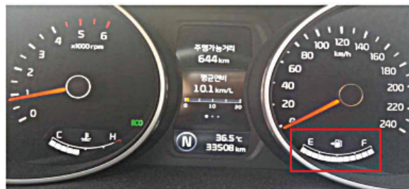
Şəkil 08-12: Yanacaq sistemi (idarəetmə pultunun sağ alt hissəsi)
