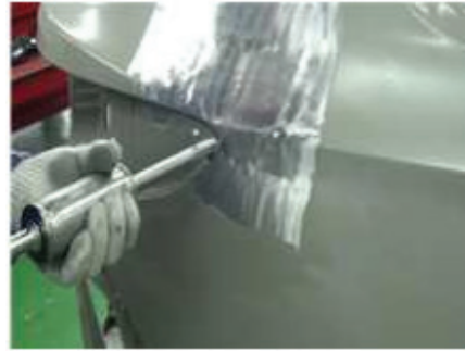
Şəkil 05-13: Qaynaq başlığı üçün tapançanın istifadəsi
