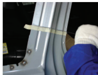
Şəkil 04-12: Panelin qaynaq tikişi boyu kəsilməsi
