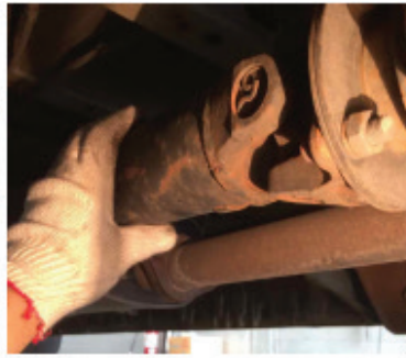
Şəkil VI, 02-2: Güc ötürməsi - Aparıcı val yastığının ara boşluğuna nəzarət
