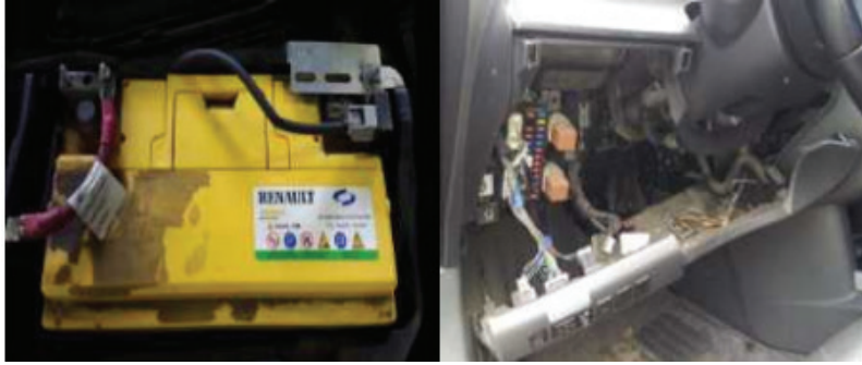
Şəkil 11-1: Akkumlyatorun ayrılması Şəkil 11-2: Aşağı paneldə toqquşma yastığının sökülüb çıxarılması
