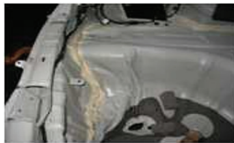
Şəkil 01-10: Panel daxili deformasiyalarının müəyyən edilməsi
