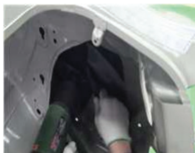
Şəkil 05-2: Səskeçirməyən üzlüklər
