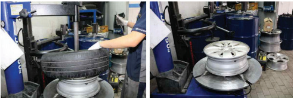
Mənbə: M Company verilənləri Şəkil 07-26: Şinin tam şəkildə sökülməsi
