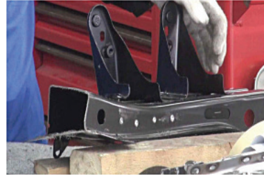
Şəkil 06-6: Panelin ayrılması
