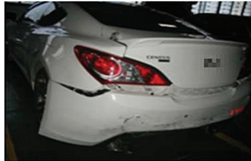
Şəkil 01-38: Arxa hissənin iş sahəsinin müəyyən edilməsi
