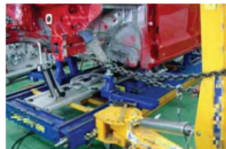
Şəkil 03-3: Dartma qurğusunun fəaliyyəti
