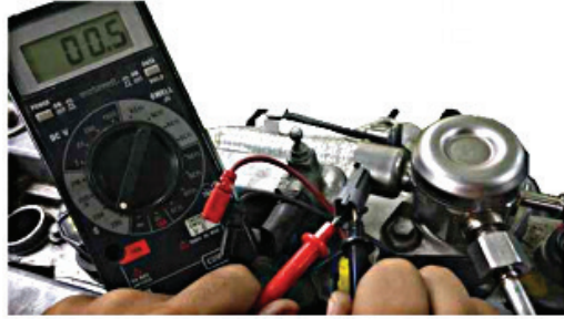
Şəkil 09-5: Yanacaq təzyiqini idarə edən klapanın müqaviməti
