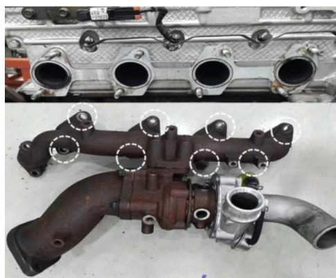
Şəkil 07-6: Turbo Şarjın Çıxarılması
