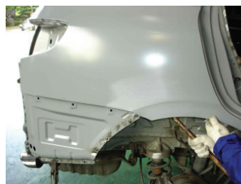
Şəkil 04-20: MIG qaynağından sonra panelin kalibrasiyası
