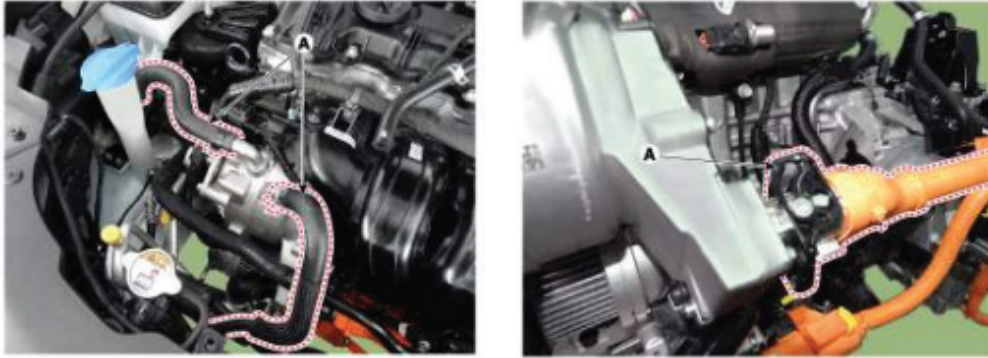
Şəkil 13-3: HİSG-nin soyutma şlanqının çıxarılması və yüksək gərginlikli enerji kabeli konnektorunun ayrılması
