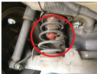
Şəkil VI, 02-7: Amortizator - Zədələnmə
