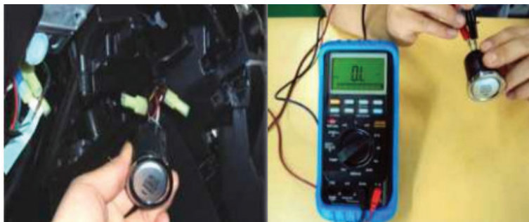
Şəkil 11-11) SSB açarının sökülməsi Şəkil 11-12: SSB açarının əməliyyatının ayrılıqda yoxlanması
