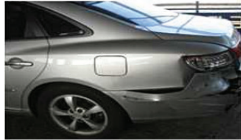
Şəkil 01-20: Sol arxa tərəfin zədələnməsinin aşkar edilməsi
