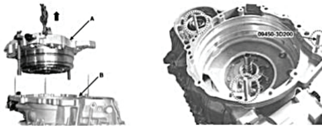
Şəkil 12-10: Motor qurğusunun sökülməsi və quraşdırma istiqamətləndiricisinin sökülməsi
