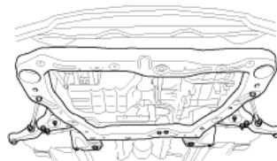
Şəkil 10-7: Montaj boltlarının çıxarılması
