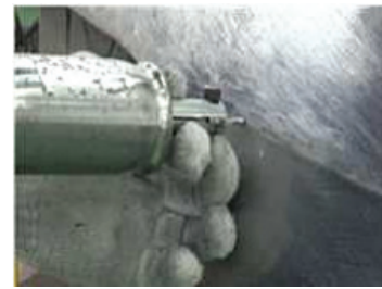
Şəkil 05-23: Zəif güc tətbiq etməklə bərpa işləri
