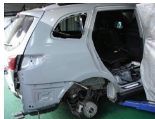
Şəkil 04-2: Zədələnmiş paneldə yeni panelin kəsilməsi
