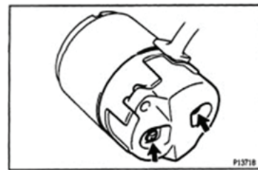
Şəkil 03-10: Karkasın sökülməsi
