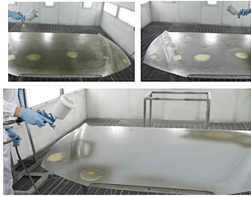
Şəkil 02-5: Reaktiv astarla tam boyama (yuxarı), qismən boyama (aşağı)
