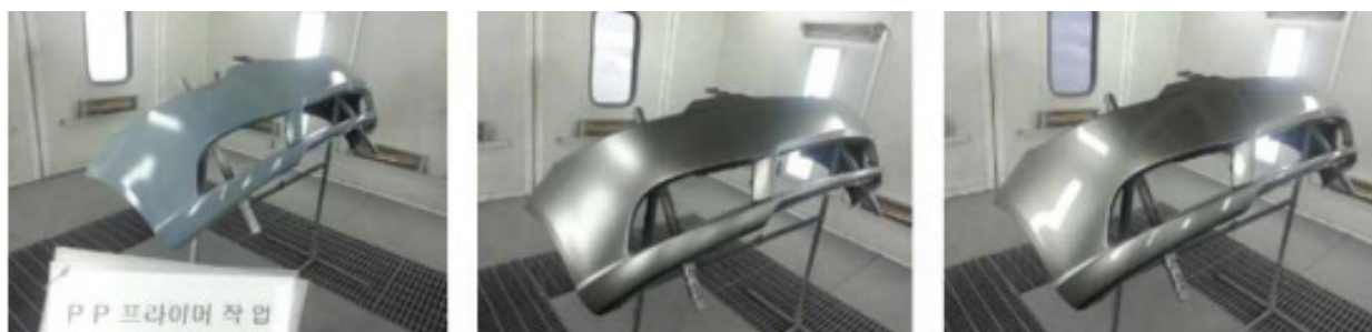
Şəkil 05-7: Quraşdırılmış kapotun xarici metal əsəşli örtük çəkilməsindən sonra şəffaf örtük boyasının çəkilməsi
