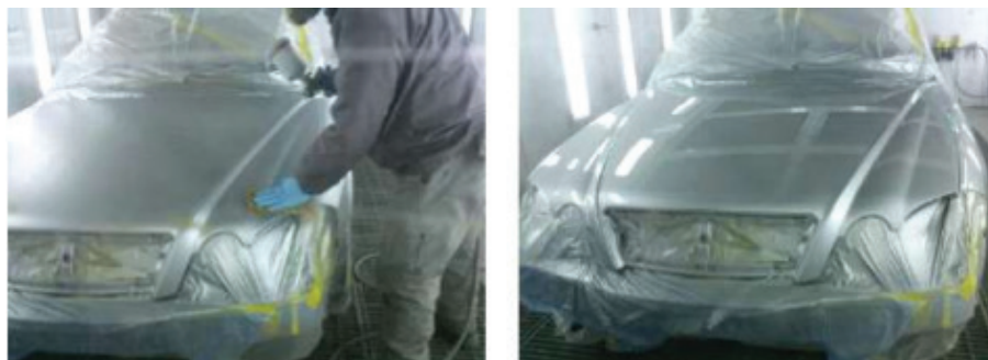
Şəkil 05-23: R/H qrupunun 3 qat əsas örtüyünün çəkilməsindən sonra şəffaf örtüyün çəkilməsi
