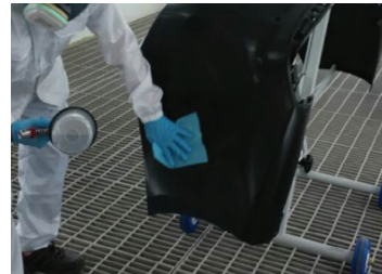
Şəkil 02-12: Hava üfürməklə yumşaq pambıq əsgilə yağsızlaşdırma
