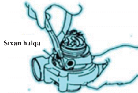
Şəkil 07-16: Kompresorun sıxan halqasının çıxarılması
