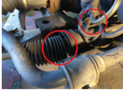
Şəkil VI, 02-4: İdarəetmə qurğusu–Güc porşenində sızma yerinə nəzarət
