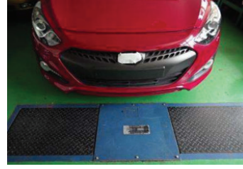
Şəkil VI, 03-2: Yana maillik üzrə sınaq cihazı qarşısında nəqliyyat vasitəsinin mövqeyi
