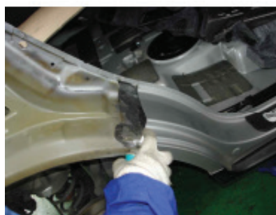
Şəkil 04-6: Panelin flans sahəsinə qaynaq etmə zamanı paslanma əleyhinə maddədən istifadə
