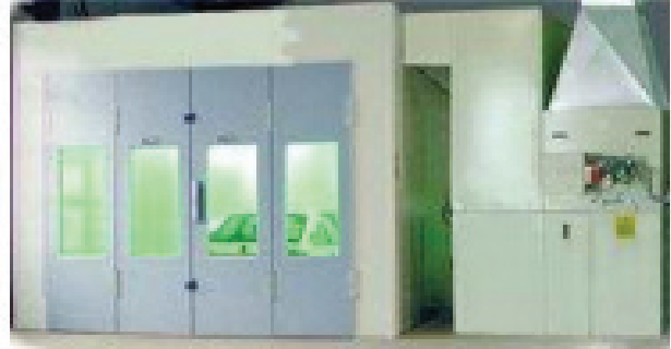
Şəkil 2-14: Tozlama yolu ilə rəngləmə kabinəsində boyanın qurudulması
