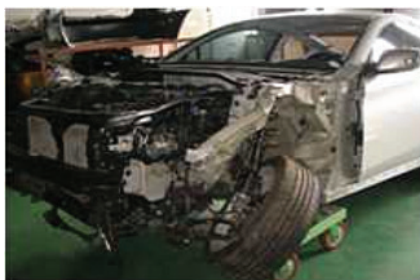
Şəkil 01-2: Struktural zədələnmənin təhlili
