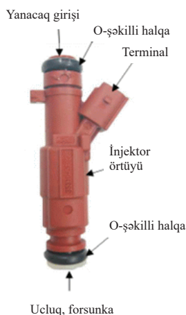
Şəkil 08-11: İnjektorun strukturu
