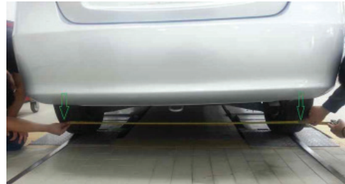
Şəkil VI, 01-6: Arxa təkər radiusunun ölçülməsi
