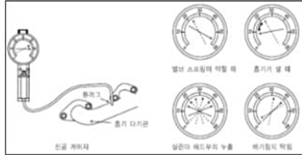
Şəkil 06-5: Qəbul manifold vakuununun yoxlanılması
