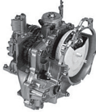
Şəkil 04-1: Avtomatik ötürülmə qutusu
