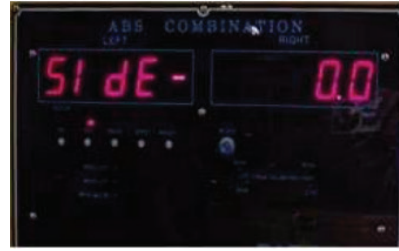
Şəkil VI, 03-3: Yana maillik üzrə sınaq cihazının sıfır nöqtəsi
