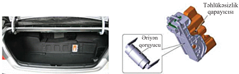
Şəkil 12-5: Təhlükəsizlik qapayıcısının mövqeyi və quruluşu
