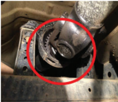
Şəkil VI, 02-1: Güc ötürməsi - Çıxış valının aralıq yastığının zədələnməsi
