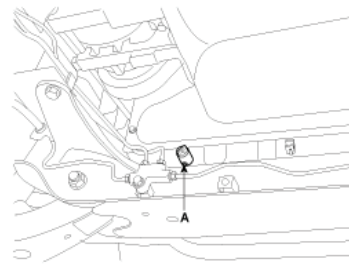
Şəkil 03-4: Drenaj tıxacı (A)
