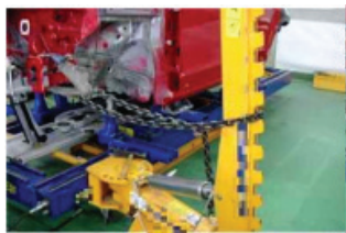
Şəkil 03-2: Təhlükəsizlik halqasının birləşdirilməsi
