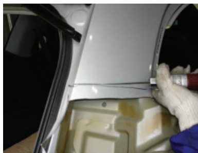
Şəkil 04-3: Kuzovun panelinin kəsilməsi
