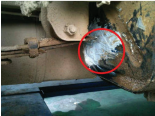
Şəkil VI, 02-11: Yanacaq sistemi - Yanacaq çənində sızıntı itkisi
