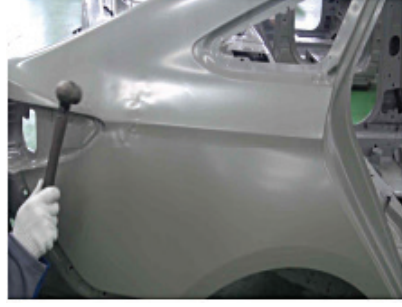
Şəkil 05-11: Panelin çöl səthinin modifikasiyası
