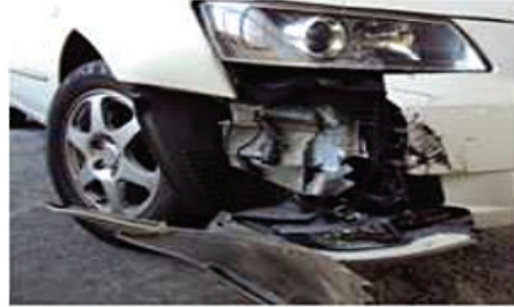
Şəkil 01-19: Yerli zədənin aşkar edilməsi
