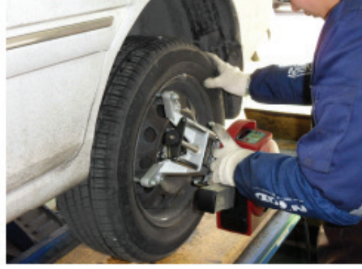
Şəkil 12-13: Fırlanma zamanı ətalətlə hərəkət kompensasiyası
