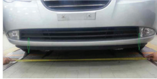
Şəkil VI, 01-5: Ön təkər diyirlənməsinin ölçülməsi
