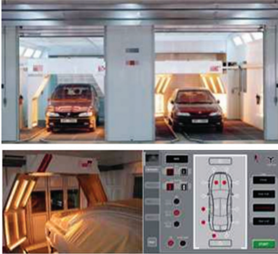
Şəkil 06-2: Boyanın tam qurudulması
