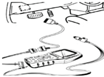
Şəkil 10-6: Skanner diaqnostik nəqliyyat vasitəsinin DAN birləşdiricisinin birləşdirilməsi.
