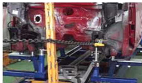
Şəkil 01-29: Çəkmə istiqamətinin müəyyən edilməsi
