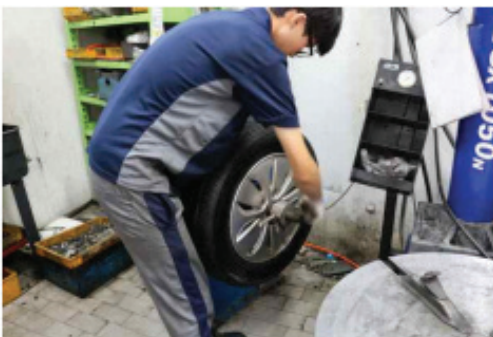
Şəkil 07-8: Təkəri tarazlıq sayğacına bərkitmə
