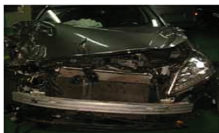
Şəkil 01-4: Qabaq hissənin sağ tərəfinin zədəsinin təhlili
