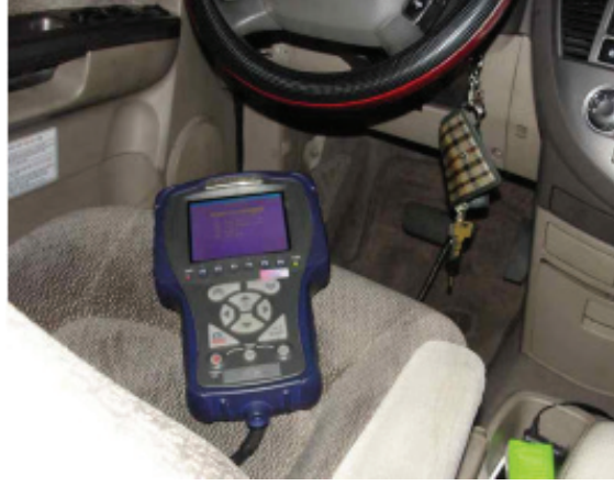
Şəkil 12-14: Diaqnoz avadanlığının birləşdirilməsi
