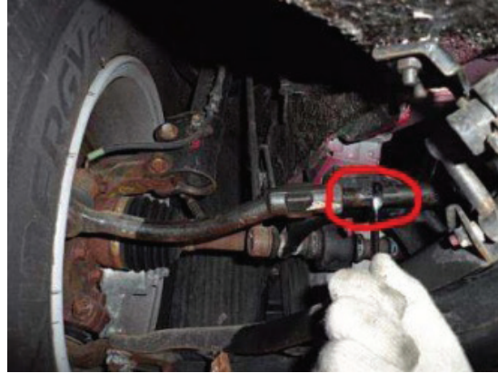
Şəkil VI, 03-8: Birləşdirici dartı uzunluğunun tənzimlənməsi
