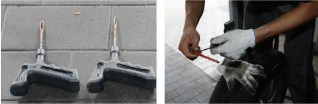
Şəkil 07-36: Tıxacı daxil etmə alətinin hazırlanması
