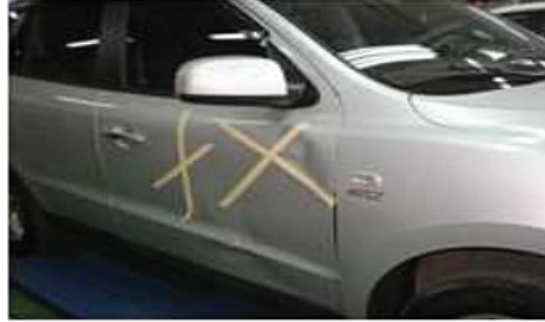
Şəkil 01-16: Obyektlərin təsiri ilə paneldə meydana gəlmiş deformasiyanın növü
