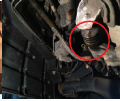
Şəkil VI, 02-3: Güc ötürməsi - İlişmə muftasının işçi silindrində sızma
