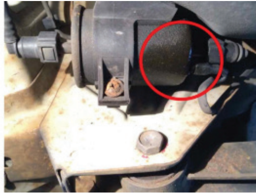
Şəkil VI, 02-12: Yanacaq sistemi - Yanacaq süzgəcində sızma
