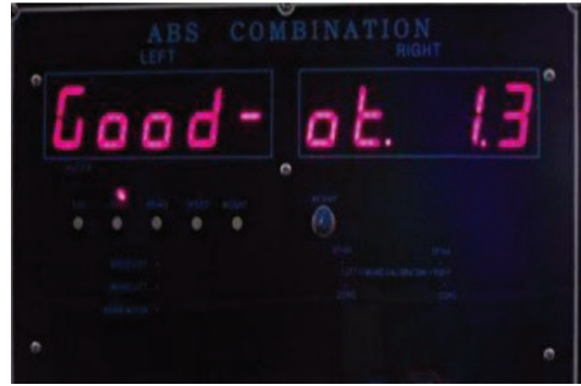
Şəkil VI, 03-7: Ekranada ölçmə dəyərini təsdiqlənməsi
