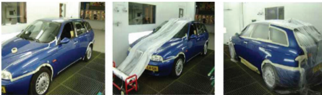
Şəkil 04-2: Kənarlardakı lövhələrə birlikdə qoruyucu örtüyün çəkilməsi
