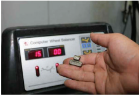
Şəkil 07-13: Çəkinin mövqeyinin və növünün müəyyən edilməsi
