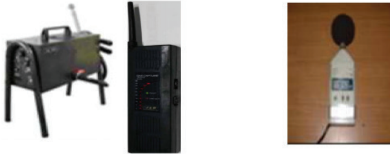
İşıq ötürmə tipli tüstü detektoru, Qaz sızması üzrə sınaq cihazı, Səs intensivliyini Ölçən Cihaz Mənbə: Nəqliyyat Təhlükəsizliyi Təşkilatı (2014). Avtomobil Yoxlanışı üzrə Manual Xidmət. səh.237.
