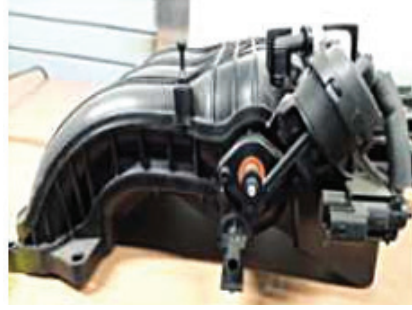
Şəkil 06-4: Qəbul manifoldunun dəyişdirilməsi
