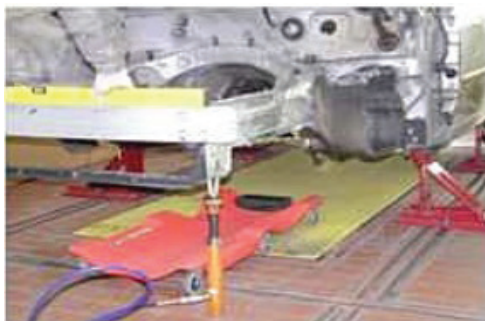
Şəkil 02-1: Döşəmə dayaq qurğusu
