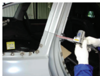
Şəkil 04-13: Panelin qaynaq edilmiş hissəsinin çıxarılması
