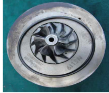
Şəkil 07-20: Kipləşdirici halqanın kaset dəstinə montajı
