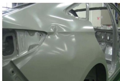
Şəkil 05-1: Yan panelin zədəsi
