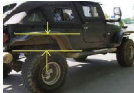
Şəkil VI, 01-10: İcazə verilən maksimum uzunluq pozulması
