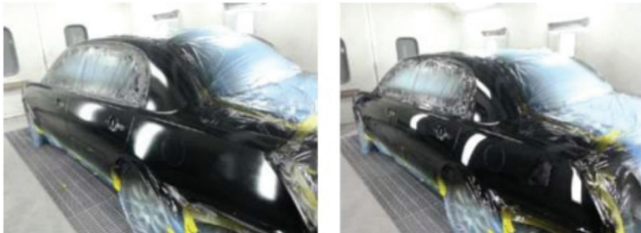
Şəkil 05-20: R/H qrupunun bərk əsasının çəkilməsindən sonra (arxa) şəffaf örtüyün çəkilməsi
