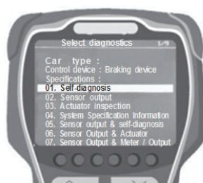
Şəkil 16-9: Hidravlik qurğunun işçi vəziyyətini yoxlanılması
