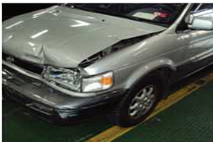
Şəkil 01-3: Qabaq hissənin sol tərəfindəki zədənin təhlili
