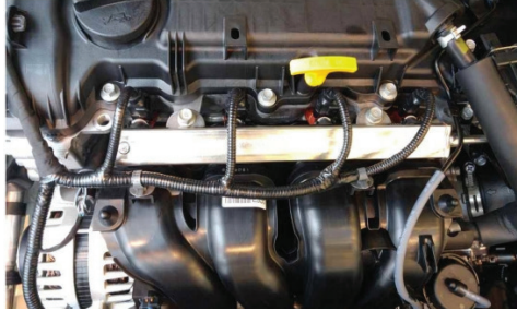
Şəkil 08-2: ÇNP üzrə yanacaq sisteminin strukturu
