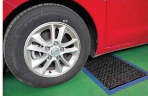
Şəkil VI, 03-6: Lövə üzərindən düz keçən yana maillik üzrə sınaq cihazı
