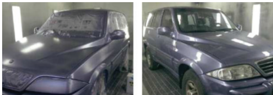
Şəkil 05-24: Avtomobilin metal əsasının (sərnişin avtomobili) çəkilməsindən sonra şəffaf boyanın çəkilməsi
