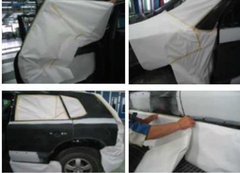
Şəkil 04-7: Ön/Arxa qapının kənar lövhəsinə qoruyucu örtük çəkilməsi
