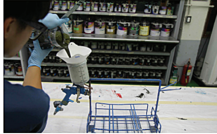
Şəkil 02-2: Reaktiv astarın filtrasiyası
