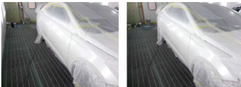
Şəkil 05-23: R/H qrupunun 3 qat əsas örtüyünün çəkilməsindən sonra şəffaf örtüyün çəkilməsi
