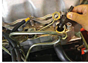
(Şəkil 11-8) Püskürdücü ucluğun çıxarılması
