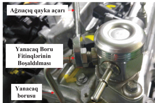
Şəkil 08-5: Yanacaq Boru Fitinqlərinin Boşaldılması
