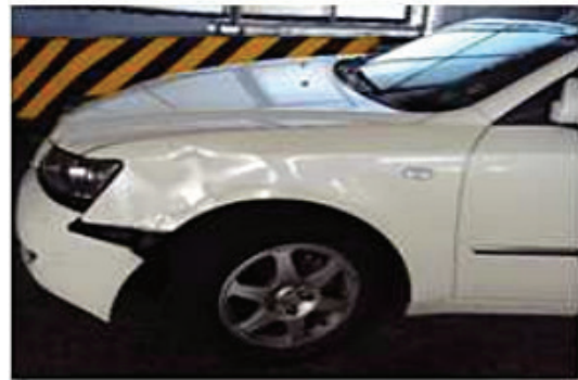
Şəkil 01-17: Qabaq hissənin aşağı bölməsinin zədəsinin aşkar edilməsi
