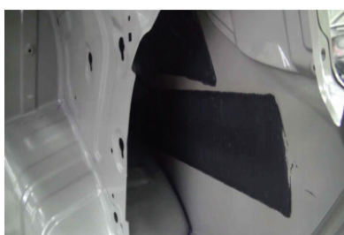
Şəkil 05-2: Səskeçirməyən üzlüklər
