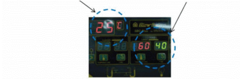
Mənbə: Yoo Chang-bae (2014). “Avtomobili boyama praktikası” səh.33. Şəkil 05-30: Məcburi qurutma üçün termiki emala hazırlıq
