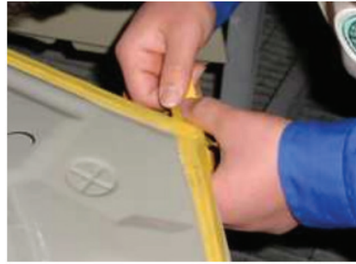
Şəkil 04-4: Kapotun qoruyucu örtüyünün daxilindəki xəttə basmaq
