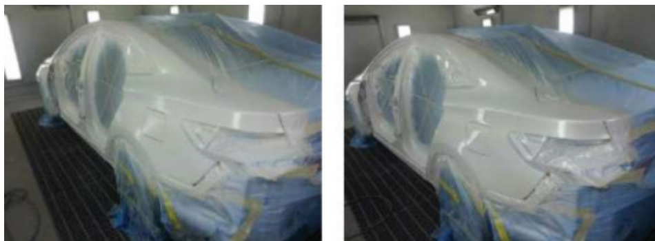
Şəkil 05-22: L/H qrupunun 3 qat əsas astarının çəkilməsindən sonra şəffaf örtüyün çəkilməsi
